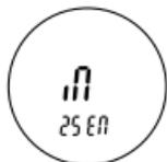
**2. SEп: Выбор датчика.** С помощью кнопок «вверх» ▲ и «вниз» ▼ выберите режим работы: in — датчик воздуха, OUT: датчик пола, ALL: оба датчика (датчик пола ограничительный). Нажмите кнопку «меню» для перехода в следующий шаг.
