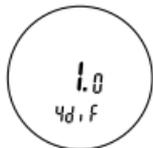
**4. dIf: Шаг регулировки температуры.** С помощью кнопок «вверх» ▲ и «вниз» ▼ установите шаг регулирования температуры. Диапазон от 0.5 до 10°C. Нажмите кнопку «меню»
