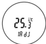
**1. AdJ: Калибровка температуры.** С помощью кнопок «вверх» ▲ и «вниз» ▼ откалибруйте температуру. Предел калибровки +9.9°C. Нажмите кнопку «меню»
