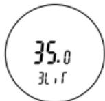
**3. Lir: Ограничение температуры пола.** С помощью кнопок «вверх» ▲ и «вниз» ▼ установите для ограничения максимальную температуру поверхности пола. Предпочтительно не более 35°C. Нажмите кнопку «меню»
