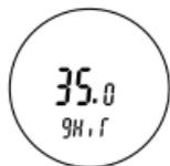
**9. Hlr: Установка максимальной температуры.** С помощью кнопок «вверх» ▲ и «вниз» ▼ установите максимальную температуру в диапазоне +35—90°C. Нажмите кнопку «меню» ☰ для перехода в следующий шаг. Не используйте данную функцию с электрическими системами обогрева «теплый пол».
