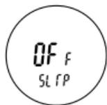
**5. LrP: Режим антизамерзания при выключенном терморегуляторе.** С помощью кнопок «вверх» ▲ и «вниз» ▼ выберите режим «ON» — на дисплее появится значок «снежинка» ❄. Не используйте данную функцию с электрическими системами обогрева «теплый пол».
